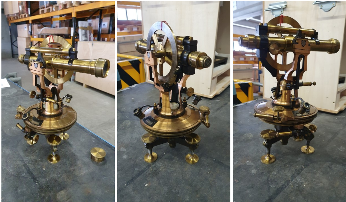
Abb. 39: Repetitionstheodolit aus der Zeit des Gotthardtunnelbaus; O. Gelpke als Benutzer zugeschrieben (Sammlung VHS, Nr. 3525 , 1875)
