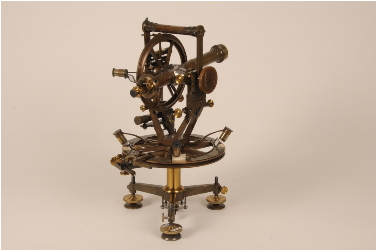
Abb. 28: Theodolit Kern aus dem Jahre 1874 (swisstopo 2012)
