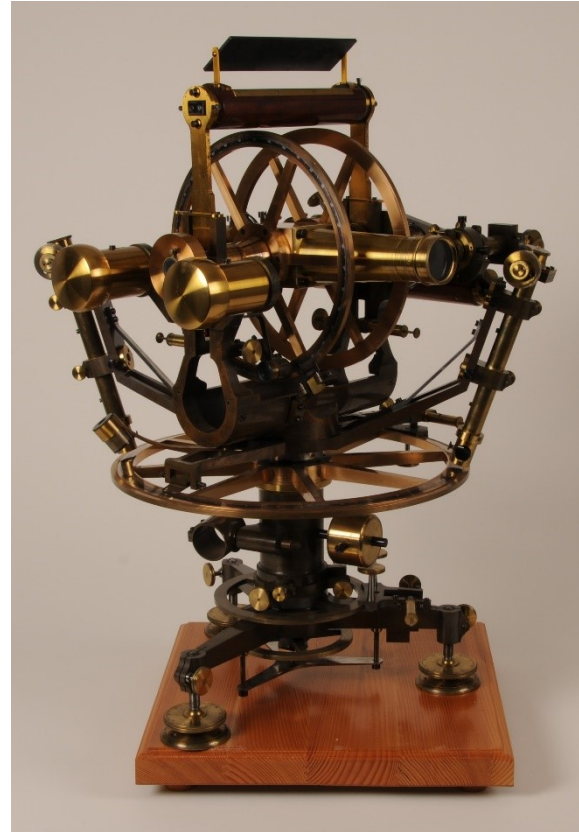
Abb. 29: Ertel Universal-Instrument der S.G.K, 1863 hergestellt (swisstopo 1948, 2012)
