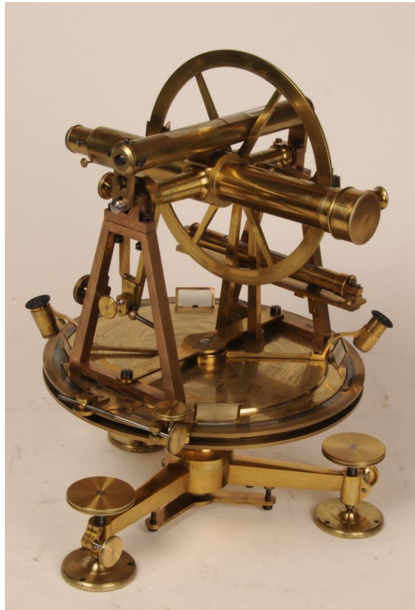
Abb. 18: Gelpkes 9" Theodolit von Starke zur Bestimmung der Gotthard-Tunnel Achse 1869 (swisstopo Bild 5490, 2012)
