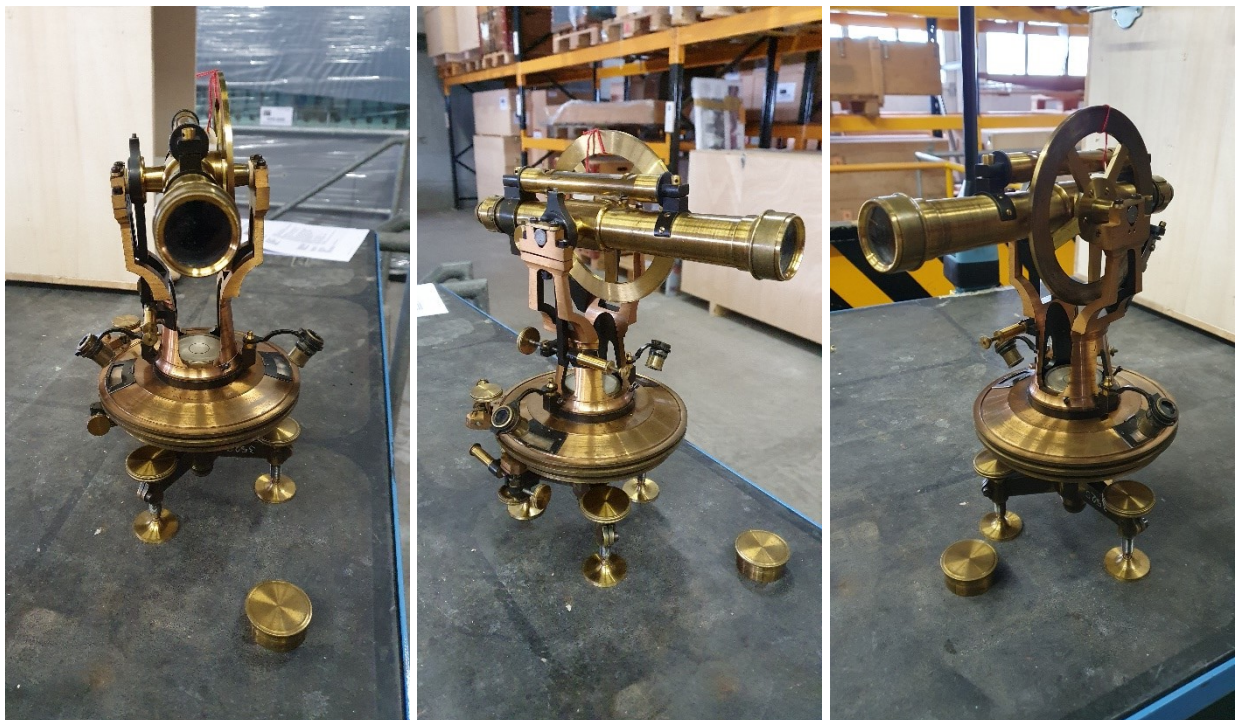
7" Theodolit von Otto Fennel auf Fussplatten gestellt, mit abgenommener Fernrohrabdeckung vorne
